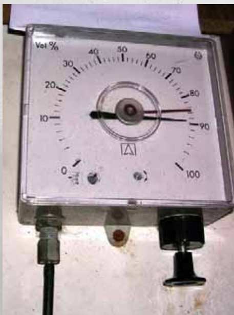
Grâce à une jauge pneumatique , on pourra toujours contrôler le niveau d'eau dans la citerne.
