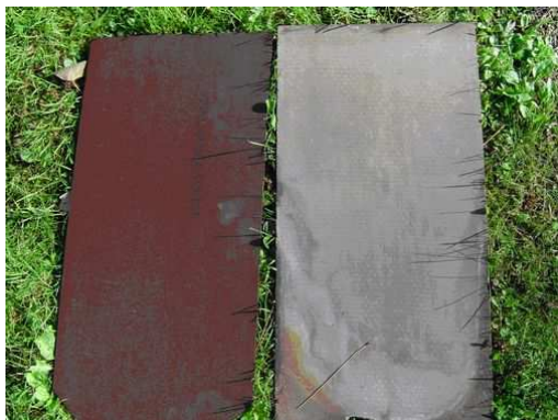
Photo 1 : À droite une ardoise en amiante-ciment (empreinte gaufrée) et à gauche une ardoise sans amiante (mention « NT »)
